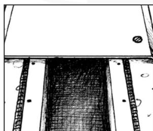
Couvre joint fixé mécaniquement ou collé avec mastic VEDAFLEX SIL.
