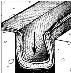
S'assurer que les bords du joint sont droits et propres pour permettre un bon contact entre la nappe et le support.
