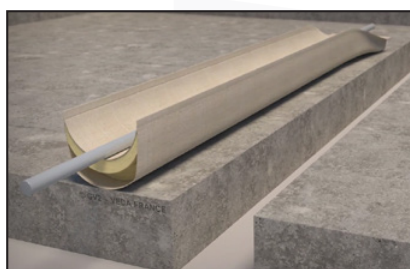
Préformer la nappe en U en la pliant dans sa partie centrale.
