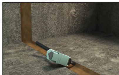
Con ayuda de una clavadora neumática, fije las aletas cada 20 cm.
