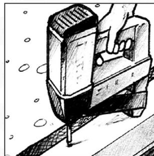
Mantener la presión en el canalón antes de fijar con la pistola neumática.
