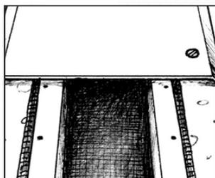
Cubrejunta fijado mecánicamente o con masilla VEDAFLEX SIL.
