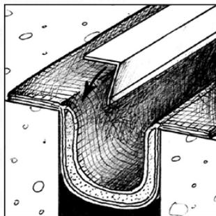
Apretar bien la capa contra el hormigón usando el canalón.
