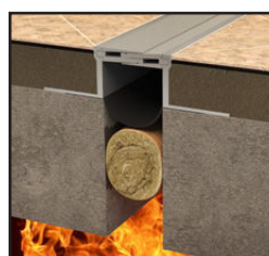
Cinta selladora con capa cortafuegos y junta de dilatación mecánica
