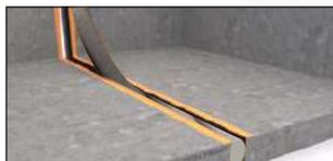
Introduire le fond de joint à une profondeur minimum de 10 mm.
