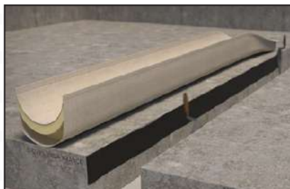
Encoller les deux côtés du joint sur une profondeur de 90 mm environ à l'aide de la VEDACOLLE ® .
