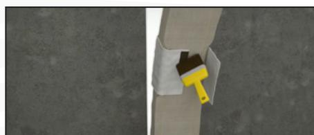
Entourer le raccord VEDAFEU autour du raccordement et le fermer avec une bande de colle.
